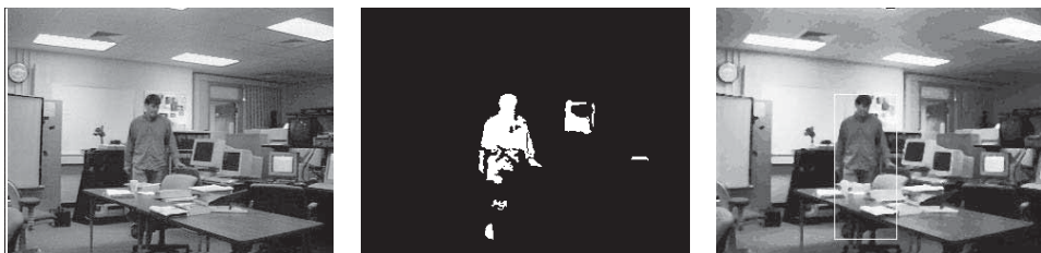
Рис. 9.1. (Слева) в ранее свободной области рабочего пространства появляется фигура человека. (В центре) вычитание изображений выявило три области изменений: фигура человека, закрывшая изображение фона, область двери и след кадровой развертки на мониторе. (Справа) изменения, вызванные появлением человека, считаются значимыми и фиксируются. Изменения в двух других областях считаются допустимыми и поэтому игнорируются. (С любезного разрешения S.-W. Chen.)
