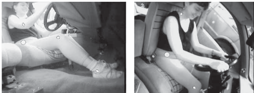
Рис. 13.1. Изображения водителя, полученные с помощью двух из четырех установленных в автомобиле видеокамер. Измерительная система с несколькими камерами применяется для вычисления трехмерных координат характерных точек на теле водителя (на рисунке они отмечены яркими эллипсами) и последующего определения его позы. (С любезного разрешения Herbert Reynolds, Лаборатория эргономики Университета штата Мичиган.)
