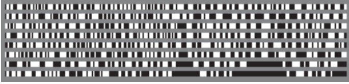
Рис. 16.7. Графическое представление 2048-битного кода, значения битов которого определяются знаками результатов применения фильтров Габора различных размеров к областям внутри 8 полос образа радужной оболочки, показанных на рис. 16.5. (С любезного разрешения John Daugman, Кембриджский университет.)
