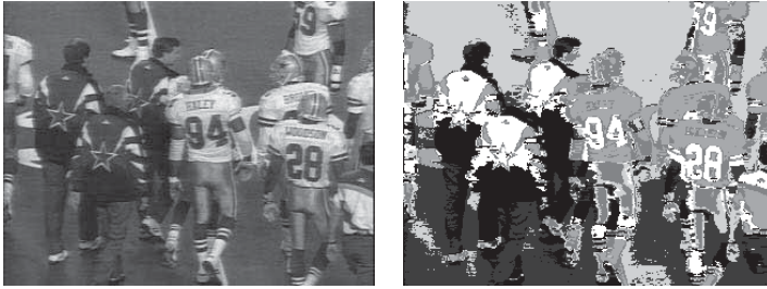
Рис. 10.4. (Слева) изображение футбольной игры. (Справа) на полутоновом изображении представлены K = 6 кластеров, сформированные с помощью алгоритма кластеризации по математическому ожиданию. Шесть кластеров соответствуют шести преобладающим цветам исходного изображения: темно-зеленый, зеленый, темно-синий, белый, серебристый и черный. См. цветную вклейку.
