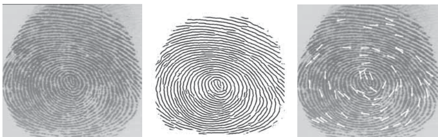
Рис. 5.2. (Слева) оригинальное изображение отпечатка пальца. (В центре) изображение, улучшенное посредством выделения и утоньшения линий. (Справа) обнаружение специальных признаков — минюций (minutia). Это локальные признаки папиллярного узора, которые могут использоваться для сопоставления неизвестного отпечатка с описаниями миллионов отпечатков из базы данных. (С любезного разрешения Shaoyun Chen, Anil Jain.)
