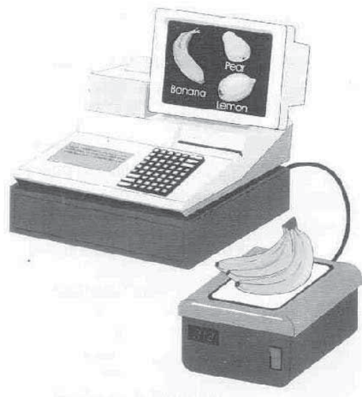
Рис. 16.1. На эскизе, выполненном дизайнером, показан внешний вид системы для распознавания овощей и фруктов в супермаркете. (Возможные типы продуктов отображаются на экране в случаях, когда требуется взаимодействие системы с оператором.) (С любезного разрешения R. Bolle и J. Connell.)
