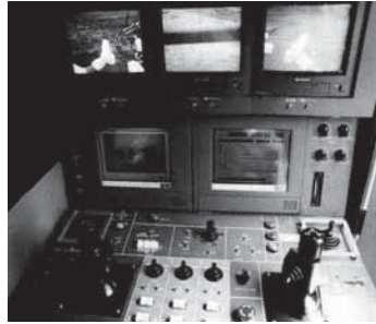
Рис. 15.9. Система для ремонта линий электропередачи Hot-Line Telerobot System компании Kyushu Electric Power. (Слева) дистанционно управляемый робот ремонтирует высоковольтную линию электропередачи. (Справа) интерфейс оператора системы. (С любезного разрешения Blake Hannaford и MIT Press. Воспроизведено по изданию К. Goldberg, The Robot in the Garden , Cambridge, MA: The MIT Press, 2000.)
