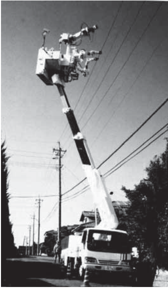
Рис. 15.9. Система для ремонта линий электропередачи Hot-Line Telerobot System компании Kyushu Electric Power. (Слева) дистанционно управляемый робот ремонтирует высоковольтную линию электропередачи. (Справа) интерфейс оператора системы. (С любезного разрешения Blake Hannaford и MIT Press. Воспроизведено по изданию К. Goldberg, The Robot in the Garden , Cambridge, MA: The MIT Press, 2000.)
